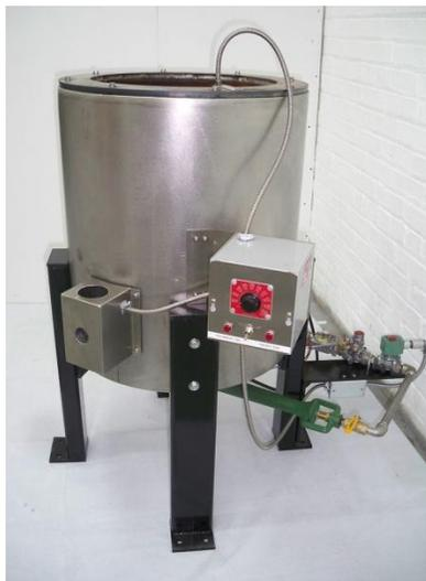
(上图) 型号 MPM1002。熔炉完全绝缘以节省能源，配备排气配件，可连接到 8 英寸管道。侧装恒温器可连接 120 或 240V 电压，并且可根据您的要求更改支腿长度。
