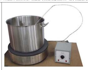
型号为 HP18S16 的加热板配有一个 5 加仑的汤锅。请注意,远程恒温器的热电偶浸入锅中,因此加热板是通过流体温度而不是板表面来控制的
