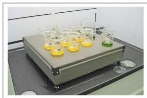
(上图)这张照片是在客户的工厂拍摄的,展示了型号为 HP1218CR 的耐腐蚀工业加热板在通风橱下加热各种酸。Wenesco 的远程温度 控制器不可见,因为它安全地远离了腐蚀性极强的环境。
