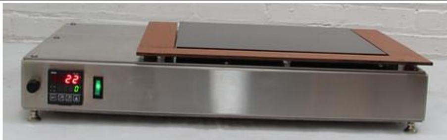
(左) HPO 系列加热板具有许多仅在高价加热板中发现的功能。这些低调、阳极氧化铝、独立式装置只有 3-7/8 英寸高,非常适合在显微镜下使用。温度由精确的数字恒温器控制,最高可达 500 F / 260C。绝缘手指托可确保操作员舒适。选择 120 或 240V 操作。HPO86 型号是 OK MODEL 570 的良好替代品
