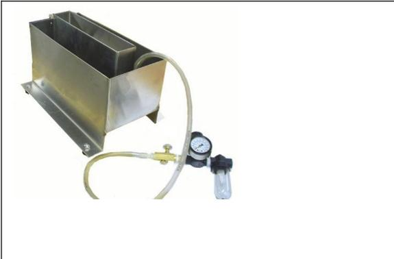
(上图) Wenesco 的 \_\_\_\_\_ 广泛用于在波峰焊之前将助焊剂喷到电路板上。它们以在泡沫喷嘴的长度上产生光滑、均匀的泡沫头而闻名。我们用不锈钢制造它们，并配有塑料配件和扩散器，以抵抗几乎所有的泡沫助焊剂。
