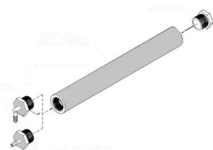
(上图) 助焊剂石由微孔塑料管制成。加压时，它们会形成由微小气泡组成的泡沫“头部”。现有泡沫助焊剂的替换石被切割成适当尺寸并安装配件。请致电索取报价。
