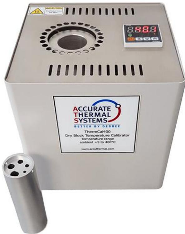
Accurate Thermal Systems 提供两种干式温度校准器，用于校准多种类型的温度传感器和系统，包括玻璃液体温度计、热电偶、RTD、PRT、热开关、温度变送器、刻度盘温度计、双金属温度计、温度控制器、手持式指示器、红外（IR）高温计、温度记录器和热敏电阻。我们的干式温度校准器的工作温度范围为 -25 至 455° C，非常适合便携式现场使用或实验室台式安装。所有设备均包含符合 ISO 17025 标准的 NIST 可追溯校准证书。可提供完全认可的 ISO17025 校准。
