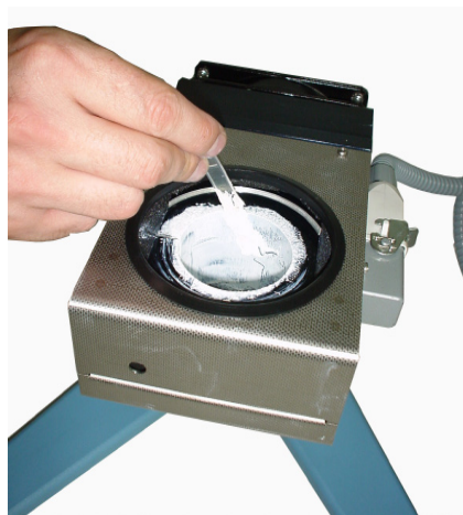
Foto A. Aplicación de pasta de silicona
