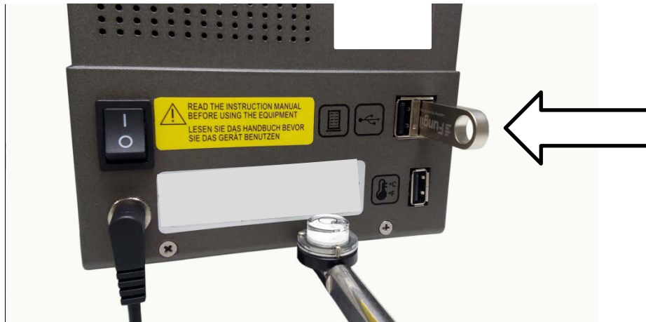
Fig. 7 Conexión de memoria USB
