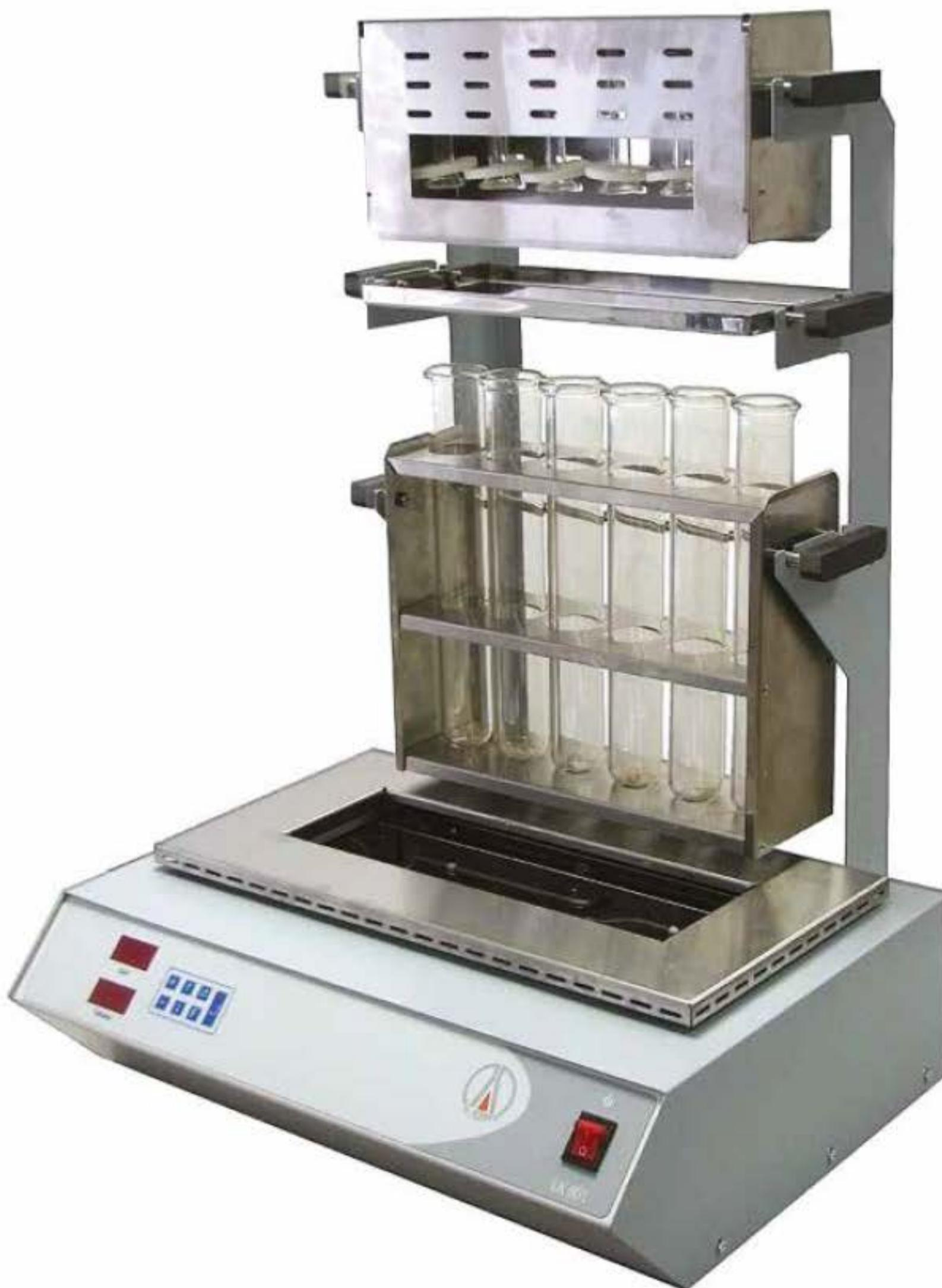
LOIP LK100 是可以同时、均匀和完整地执行消解程序的红外加热仪器。根据凯氏定氮法 (Kjeldahl) , 它广泛用于酸破坏 (氮和蛋白质的测定) 以及其他许多消解应用。
